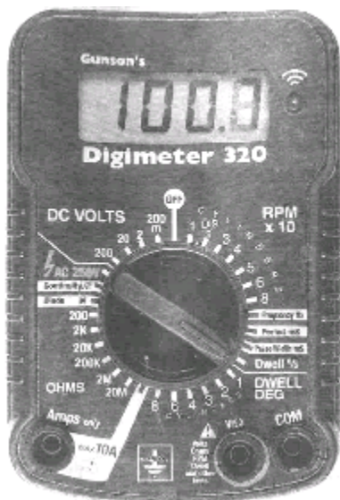
Рис.35. Многофункциональный автомобильный мультиметр "Digimeter - 320" - наиболее дешевый из распространенных в России микропроцессорных приборов для измерения параметров электрических сигналов систем управления, включая частоту, скважность и длительность импульсов
